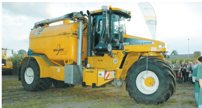
Die Bollmer Umwelt GmbH präsentierte den 300 PS starken Terra-Gator 8133 zur Ausbringung von Gülle, organischem Festdünger, Kalk und Kompost.
