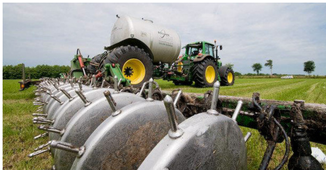
Nadeln bringen den flüssigen Stickstoffdünger gezielt in den Boden. Der Tankwagen fasst 8 500 Liter.
