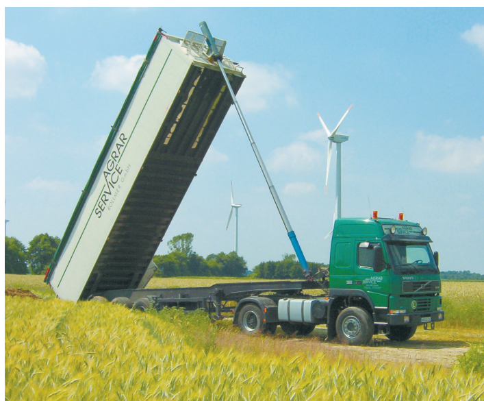
Der Kalk wird direkt vom LKW am Feldrand abgekippt.
