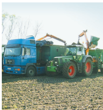
Der Kalk kann direkt vom LKW entnommen und exakt gestreut werden.
